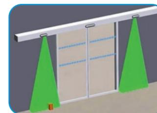
Par détection de présence, assurant une zone de protection devant le mouvement du vantail dans le refoulement.
