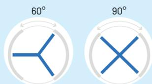
La porte tambour à trois vantaux est équipée de trois compartiments tournants, offrant un espace spacieux pour permettre aux utilisateurs d'entrer et de sortir facilement du bâtiment. La porte tambour à quatre vantaux comporte quatre compartiments tournants, offrant un peu moins d'espace, mais permettant un passage plus large et plus fluide pour l'entrée et la sortie des personnes.
