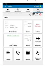
Écran de service avec fonctions et informations pour l'analyse et la maintenance du système de porte.
